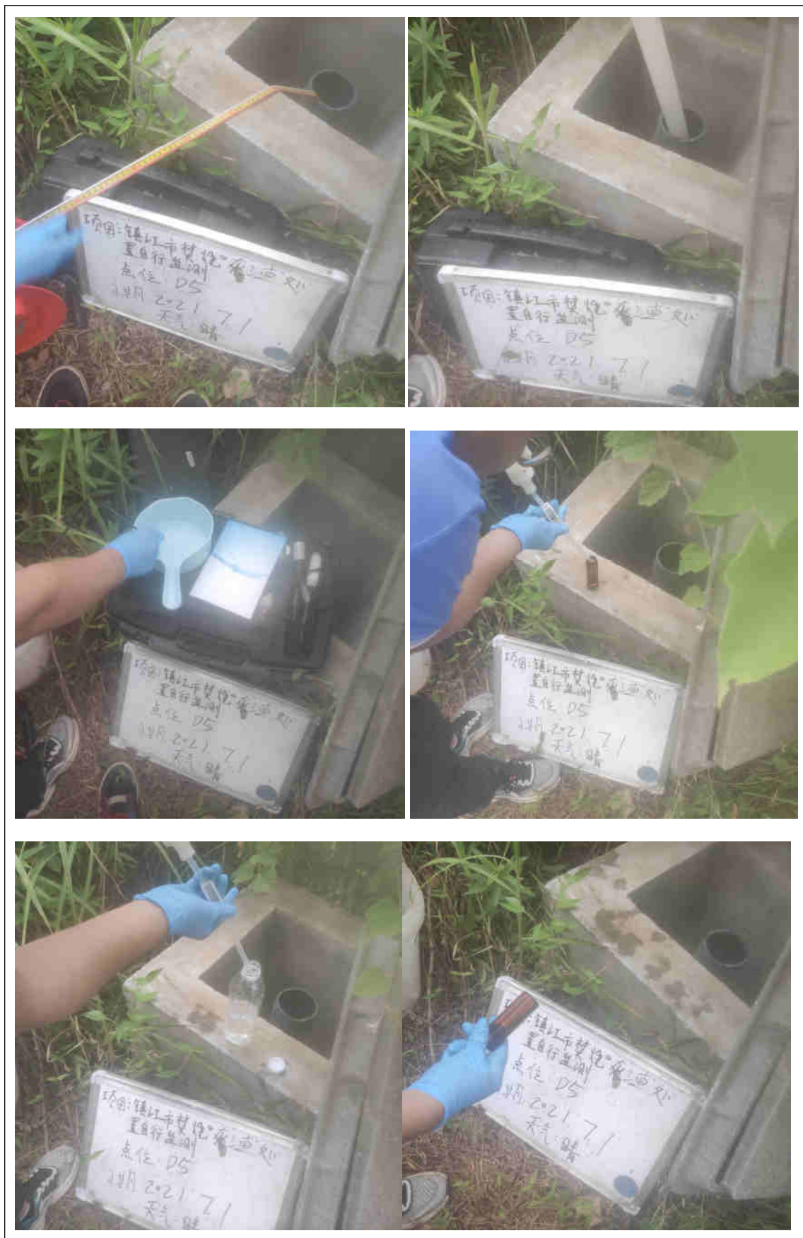
图5.4.4 地下水监测井洗井过程及样品采集过程
